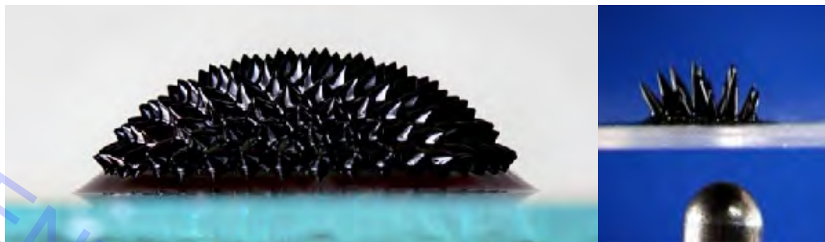
Fluido ferromagnético adoptando la forma de las líneas de fuerza de un campo magnético. Estas surgen del plano en forma ortogonal como las redes que provocan las líneas de fuerza del campo magnético terrestre.
